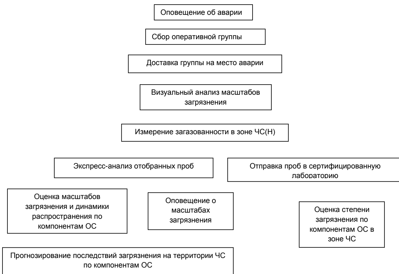
Рисунок 1 – Схема организации мониторинга обстановки и окружающей среды.
